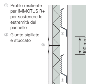
Figura 06 Giunti orizzontali nelle pareti di altezza superiore a 2,5 m
